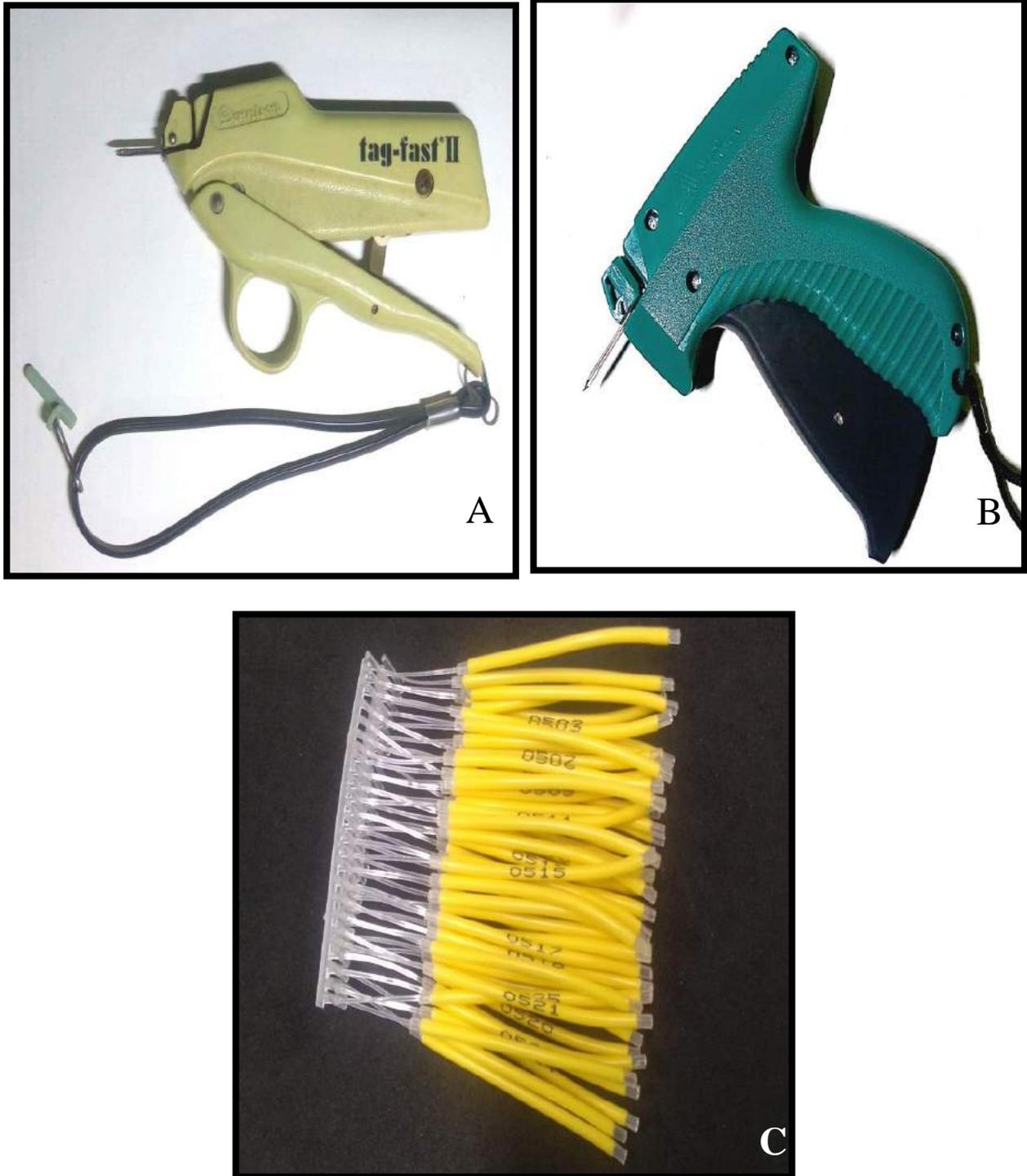
Fig. 14 A) Scissor grip tagging gun B) pistol grip tagging gun & C) floy T-Bar anchor tag
